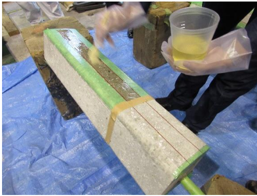
(c) Epoxy resin primer application (treatment \pm 4 hours) (d) Epoxy putty measurement (1600gr/m 2 )
