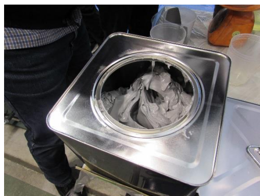
(d) Polyurea putty measurement (928gr/m 2 )
