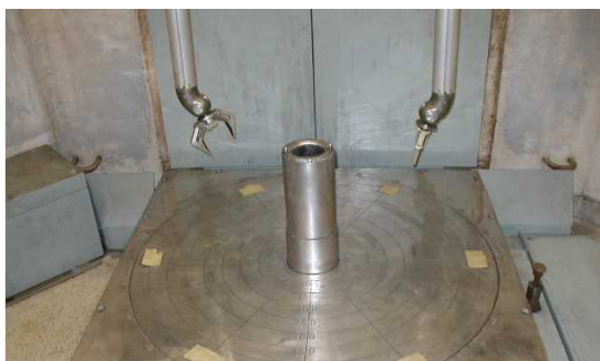
図 57-2 ガンマ線照射台とマニピュレータ
