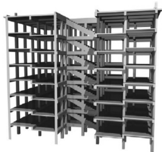
図 50 阿久井喜孝, 滋賀秀實『軍艦島実測調査資料集』 [7] の実測データを 3DCG で復元した断面図。2007（平成 19）年筆者作成。
