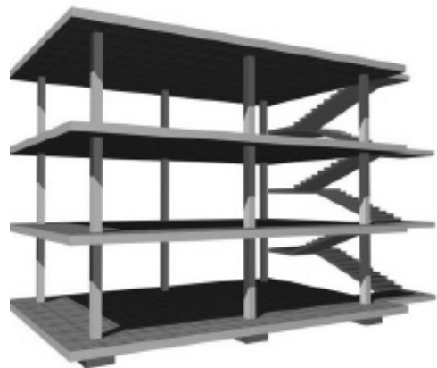
図49 コルビュジェによる「ドミノの構造」。1915(大正4)年。出典：ケネス＝フランプトン『現代建築史』[48, p. 267]。
