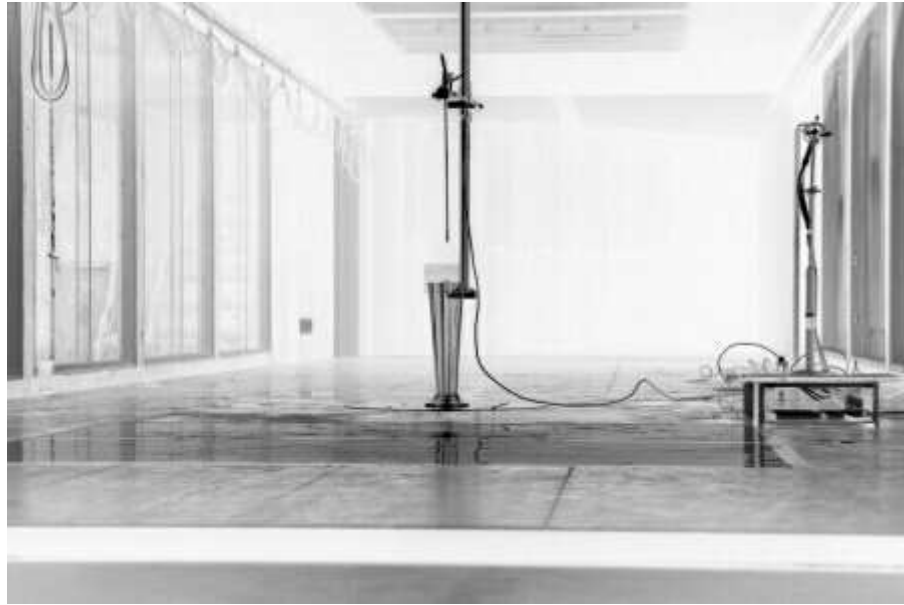
図C. 1-2 風洞内の模型および流速計測装置
