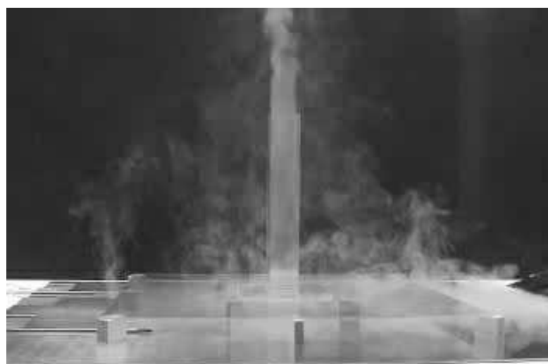
図B. 1-1 煙が塔内部を上昇する様子 （上：温度差なし，下：床面と周囲温度の差あり）
