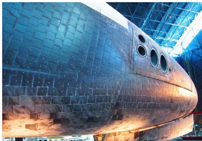
(b) HRSI tiles on Space Shuttle Discovery (Steven F. Udvar-Hazy Center)
