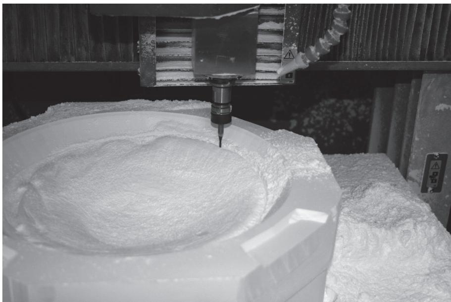
図5-11 切削加工時に発生する屑と粉塵
