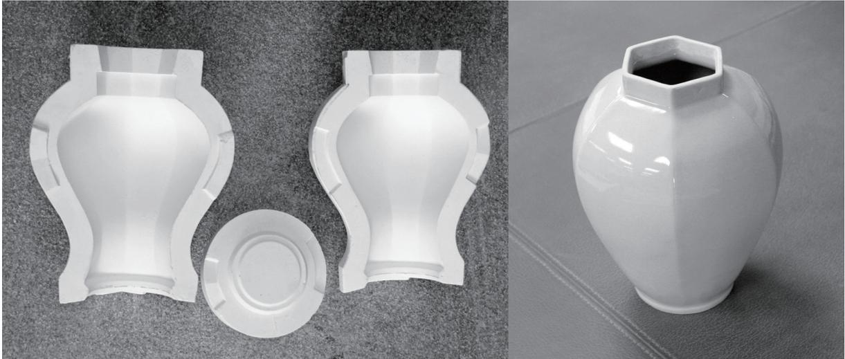
図 5-5 排泥鑄込用型の一例（左）と焼成品
