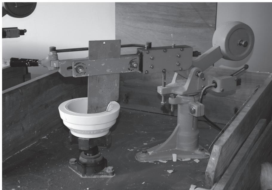
図 5-3 機械ロクロ成型機
