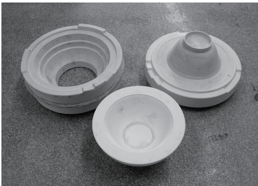
図 5-7 機械ロクロとローラーマシン成型用の型：内ヘラ（内コテ用）
