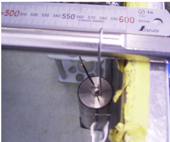
図4. 実験用ステンレス水槽内における小型塩分計の配置風景, (a) 図1より塩分計外形φが4cmであることから、水槽接触時の電気伝導度センサー中心位置は最初から水槽より2cm離れていることに注意, (b) 上部支柱から吊り下げた状態で塩分計を水平移動させ、水槽壁面との距離を調整する例
