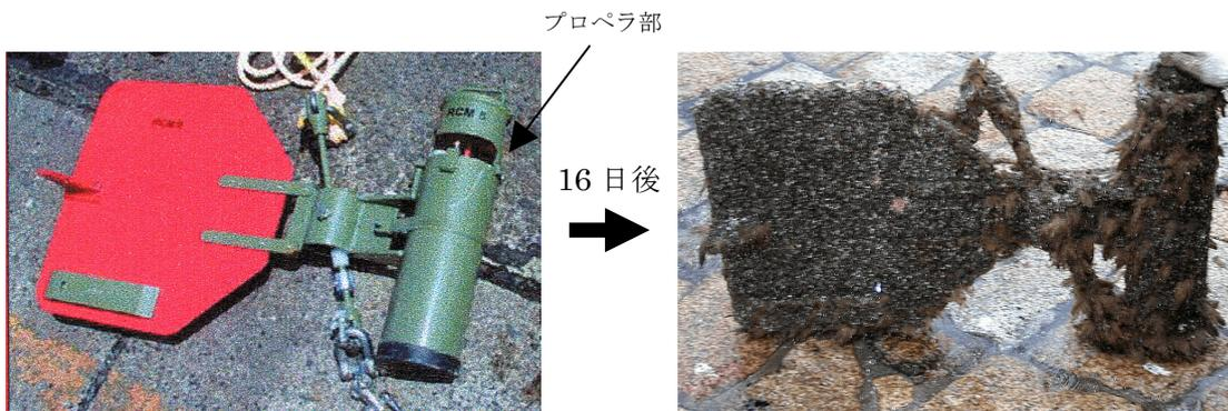
Fig.7 流速計の使用前(左)・使用後(右)
