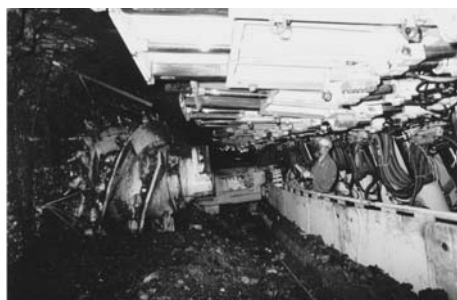
図7 SD採炭 最新型の自走枠とドラムカッター (平成9年)
