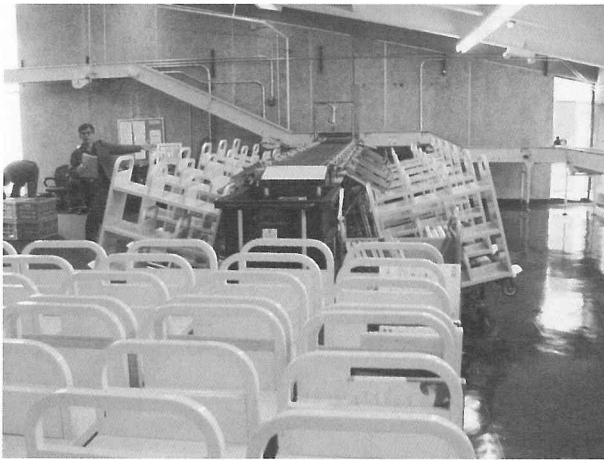
図7. 返却図書自動分類機 (ソータ)
