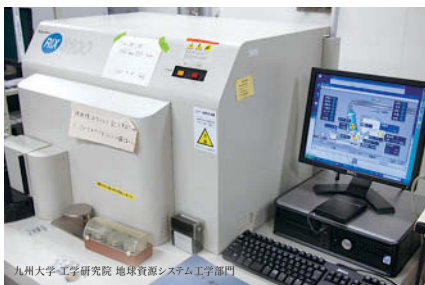
九州大学工学研究院 地球資源システム工学部門 化学組成分析に用いた蛍光X線分析装置
