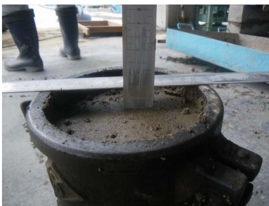
写真 6.4-6 沈下量測定状況
