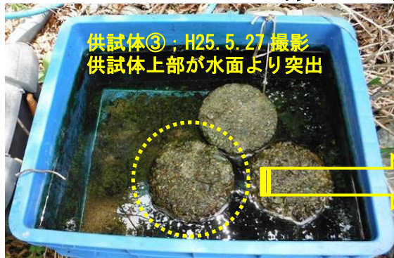
写真 4.4-8 浸水面から一部突出した曝露供試体の外観例
