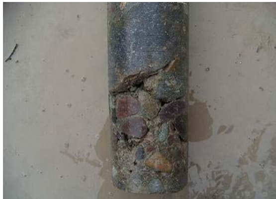
写真 5.3-3 大礫の集中によるジャンカ発生箇所 ( G_{max}=150\text{mm} )
