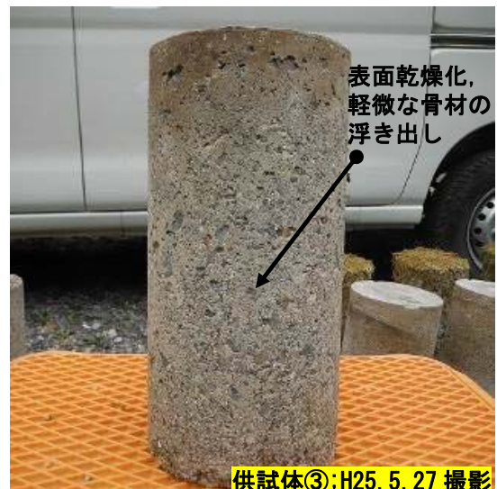
写真 4.4-7 曝露供試体の外観例
