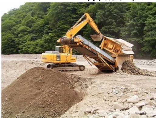
写真 5.3-6 自走式振動ふるい機による大礫除去の事例
