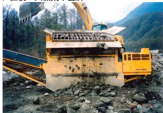
写真 5.3-6 自走式振動ふるい機による大礫除去の事例
