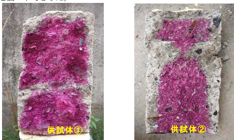
写真 4.4-10 中性化試験の例（曝露供試体）
