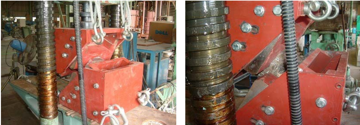
写真 5.3-1 簡易せん断試験状況例
