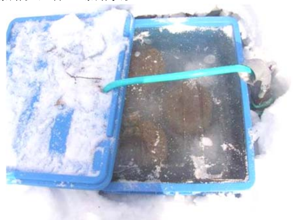
写真 4.4-3 完全浸水曝露供試体の越冬時の状況 (H19.2.8)
