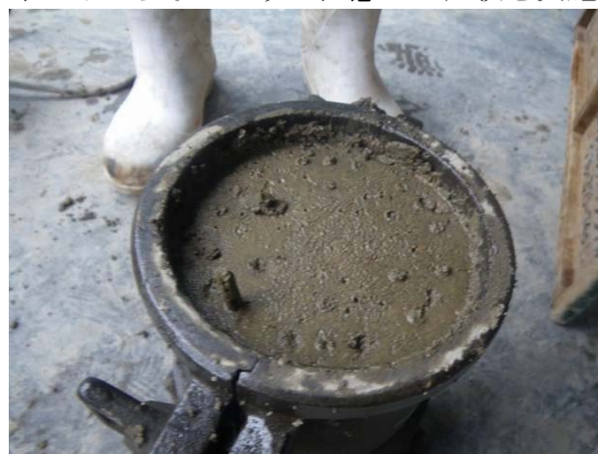
(試験終了後の供試体天端面)
