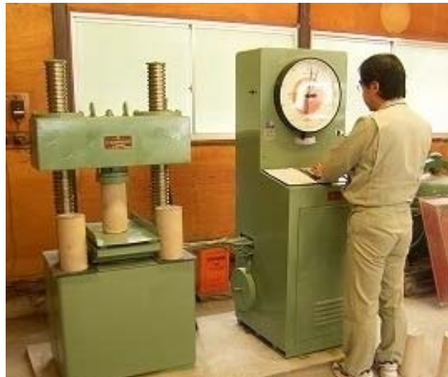
(圧縮強度測定状況事例)
