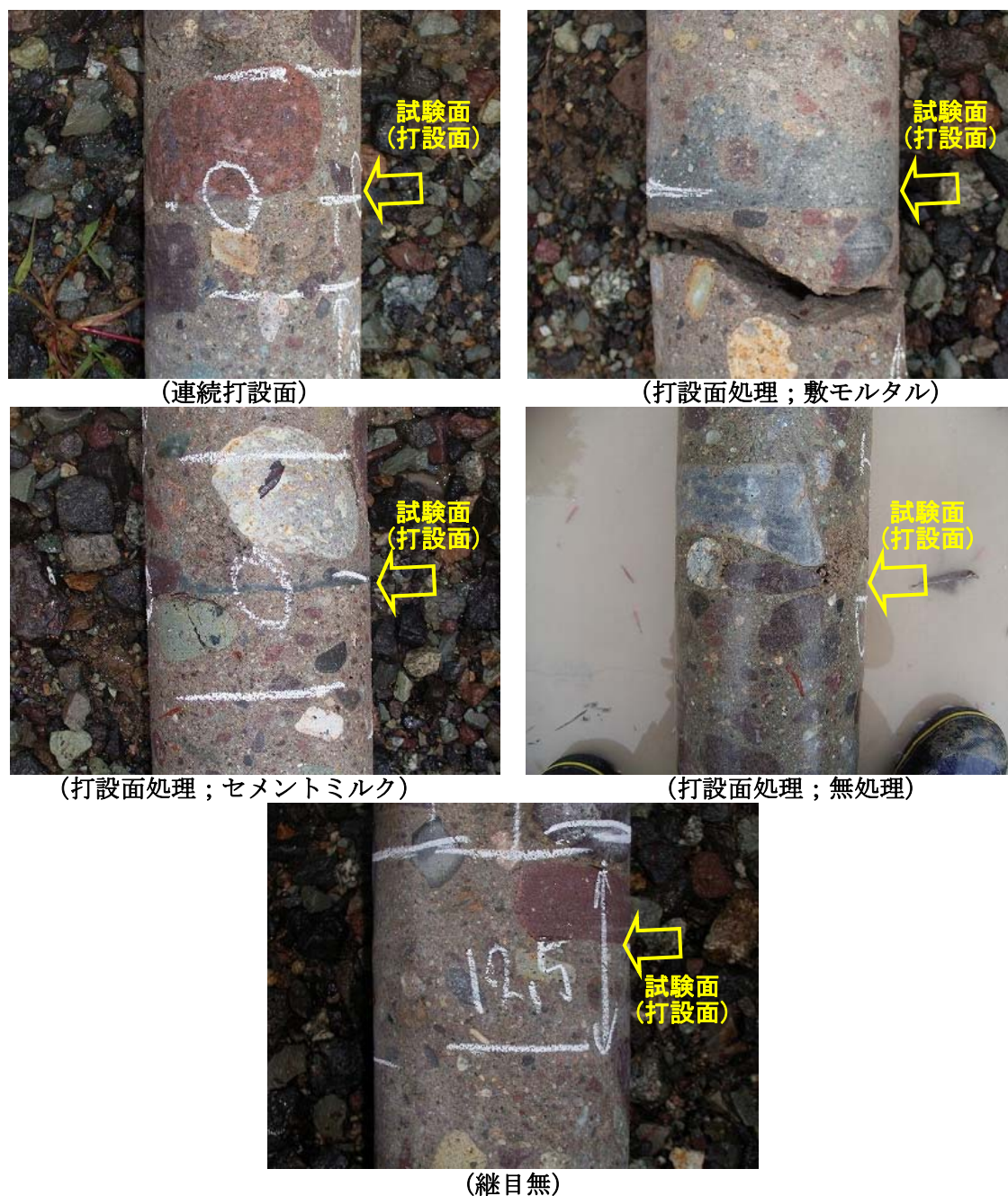
写真 5.3-2 簡易せん断試験の実施コア及び試験面の一例
