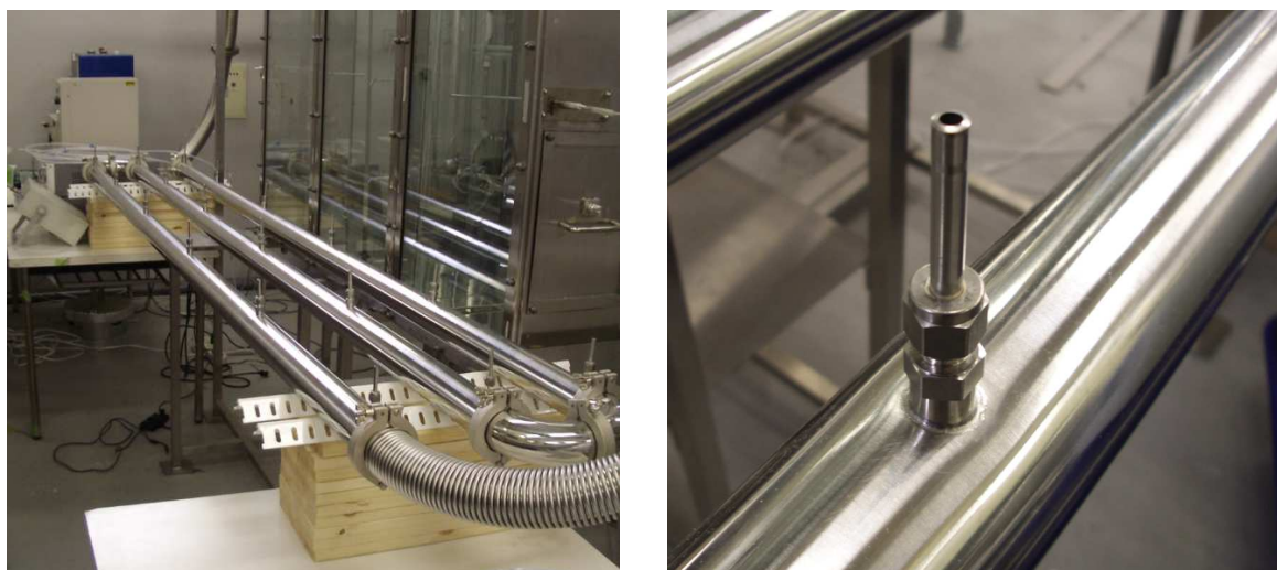
図-3.2 ダクト型実験装置(左)と測定点(右)の外観
