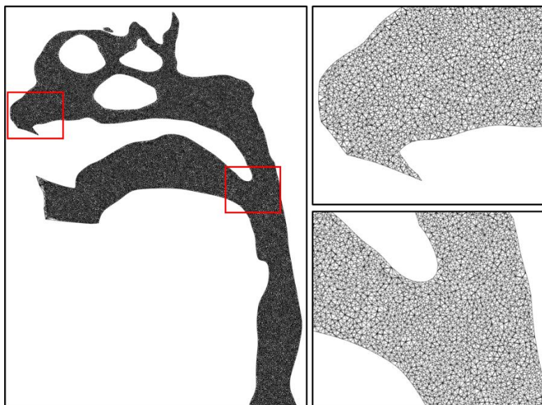
図-4.1(b) 数値気道モデル内の3次元メッシュ分割の様子
