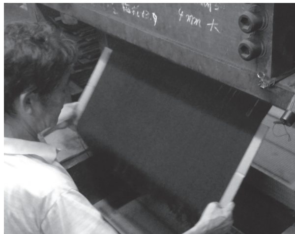
図15 杉線香の押し出し成形の様子
