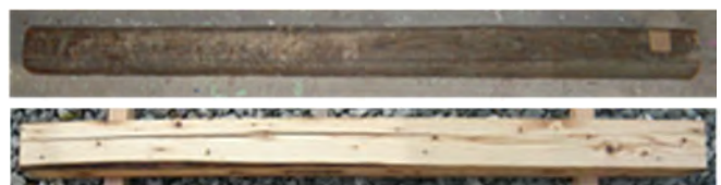
写真8 切削加工前後の木材表面（上：加工前、下：加工後）
