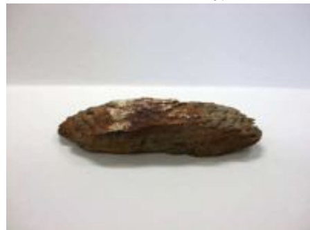
写真-3 試料Bの外観 (露出した鋼材から採取)
