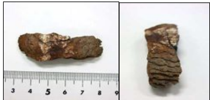
写真-1 層状の腐食生成物の一例
