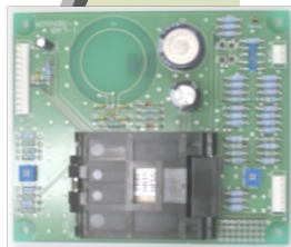
テーマ21 井上PJ 超小型電源装置 2009.6.1
