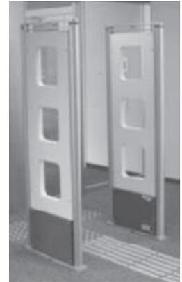
図4-1 IC タグの図書館への適用 (左上: 貸出・返却カウンタ, 左下: ハンディリーダー, 右: 不正持出防止ゲート)
