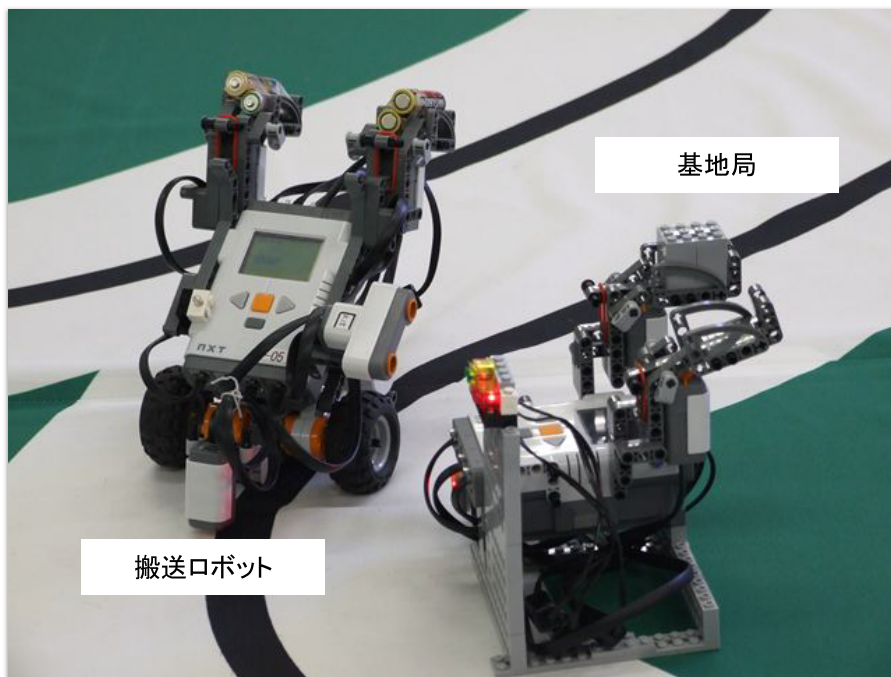
図 3.9 自動搬送ロボットと基地局の通信の様子
