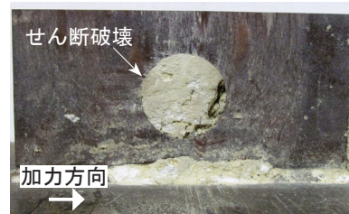
P12-0 (孔径 50mm, 板厚 12mm)
