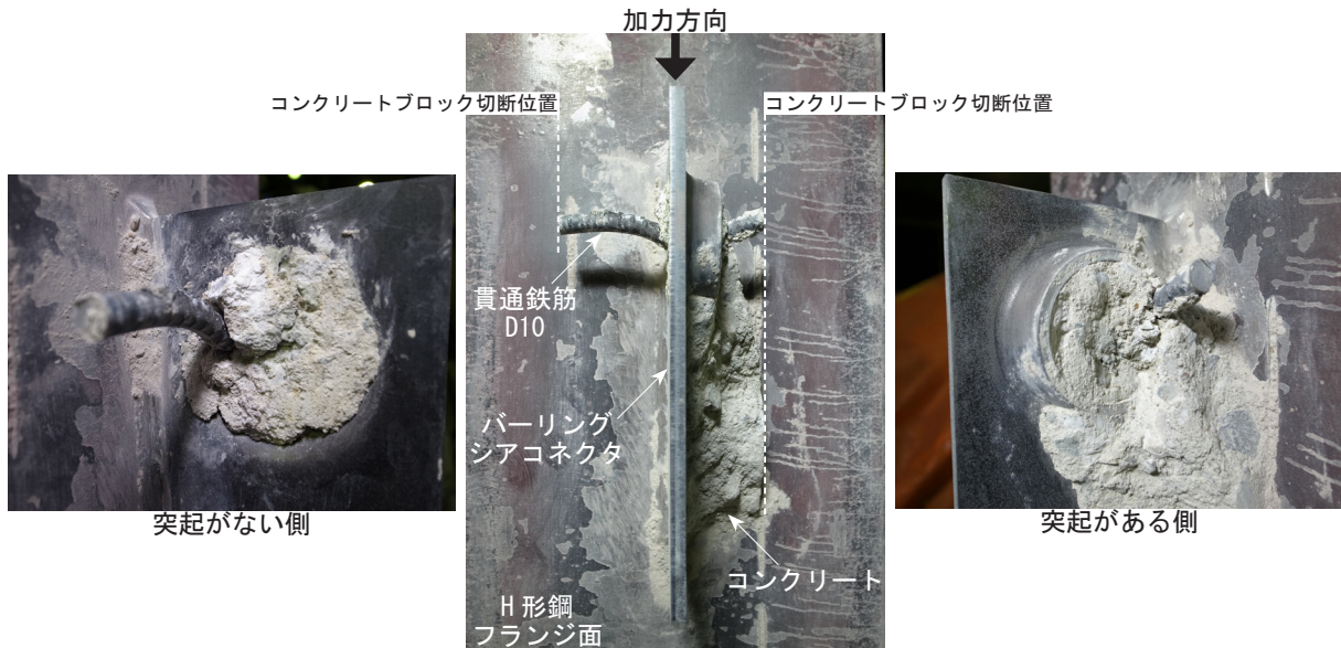
写真 6.1 貫通鉄筋を有するパーリングシアコネクタの破壊状況
