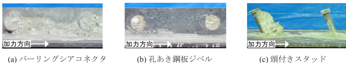
写真 7.1 押抜きせん断試験で観察された各種ずれ止めの破壊状況
