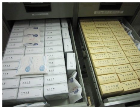
図2 ガス吸着剤の設置
