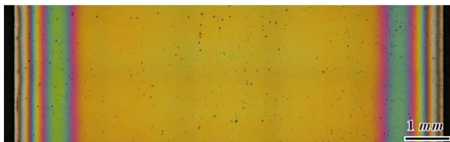
(a) 引上げ速度: 1.5 m/h (0.221 μm)
