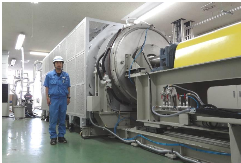
図 4-1 大型バッチ式電気炉模式図と外観写真
