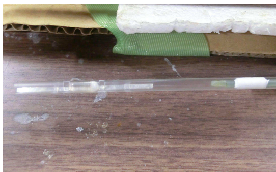
図 2.40 試料セットアップの例 (カプセル+ストロー使用時)
