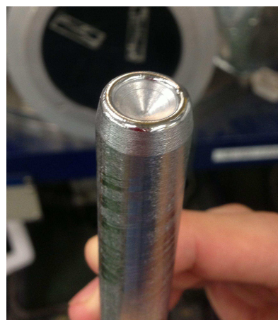
図 2.13 電子ビームにより封じたモリブデン坩堝
