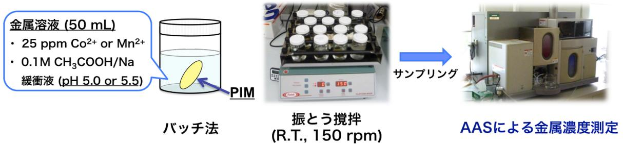
Figure 4-10. 調製した PIM を用いた金属の固相抽出実験
