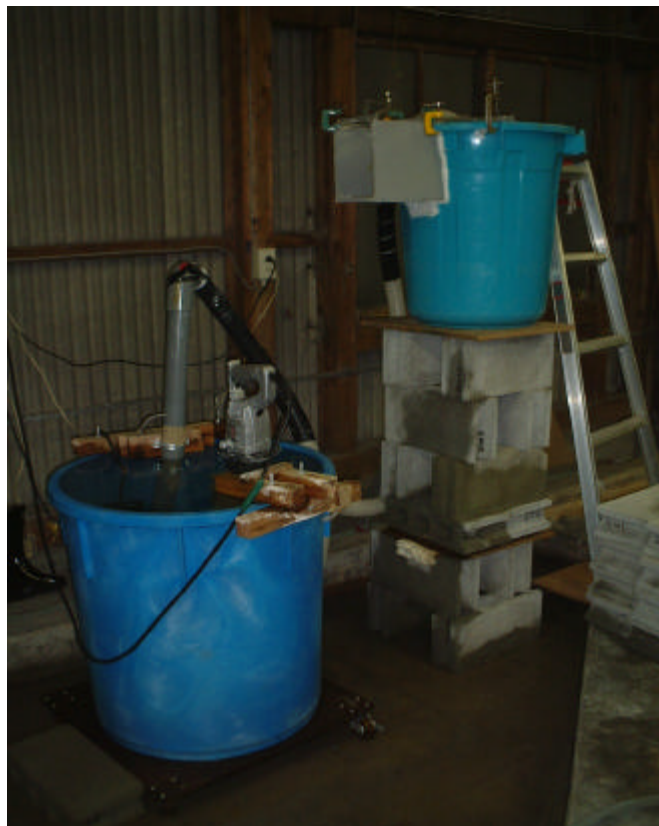
写真 4 - 2 実験装置全体図 (落下高さ H : 40cm のとき)
