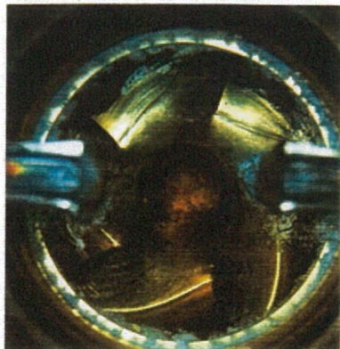
図 3.14 羽根車入口観察結果 929\text{min}^{-1} (100%Qから吸気を増加させた場合)
