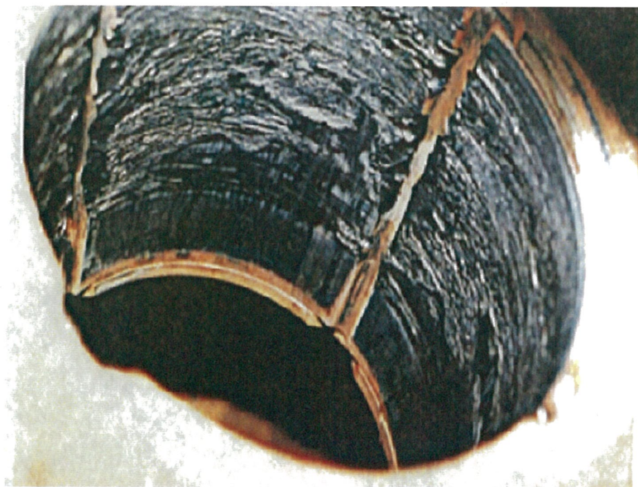
図 1.3 セラミックス軸受破損事例
