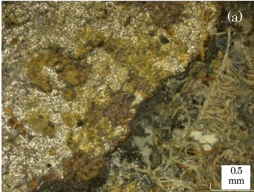
(a) 腐食生成物が剥離した鋼板表面
