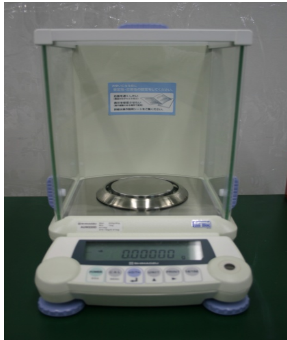
Fig.2.5 測定に用いた電子天秤 (最小分解能 0.01mg)
