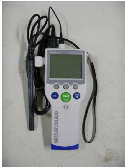
Fig.2.9 DOメーター (Mettler Toledo 社製セブンゴープロ SG6)
