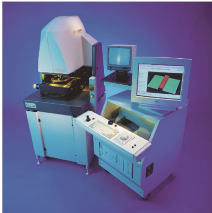
光干渉式非接触表面粗さ測定器 (Veeco 社製 WYKO NT3300)
