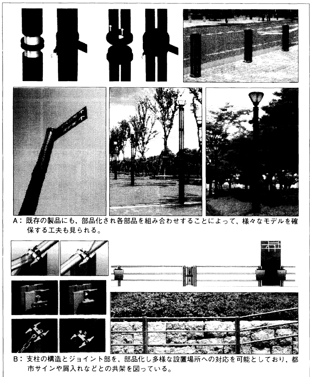
図5-1 ポール型都市環境装置の構造改良の事例（出典 [注3]）
