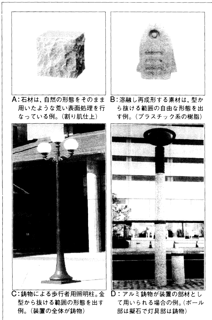
図4-36 装置の使用素材と形態<石材・樹脂・鋳物・コンクリート> (出典 [注7])
