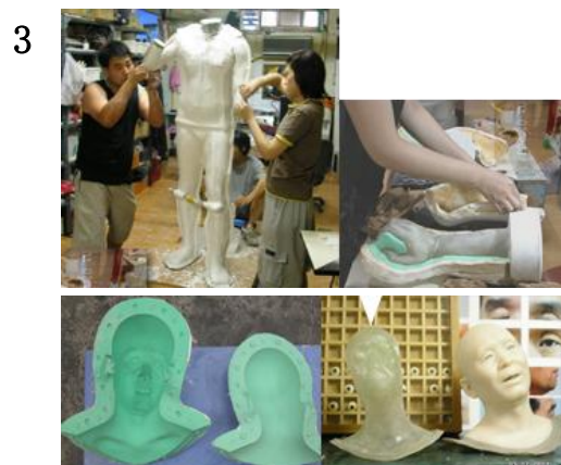
各種鋳型の製作及びスキン・シリコンによる成型作業
