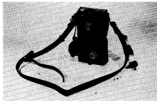
55. 東科瓦斯検定器 S10型 13462 180×95×40 東科計器株式会社製造 備考-メタン瓦斯 0~10%用
