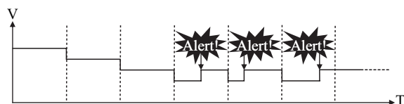
図2 カナリア方式を利用するDVSシステム
