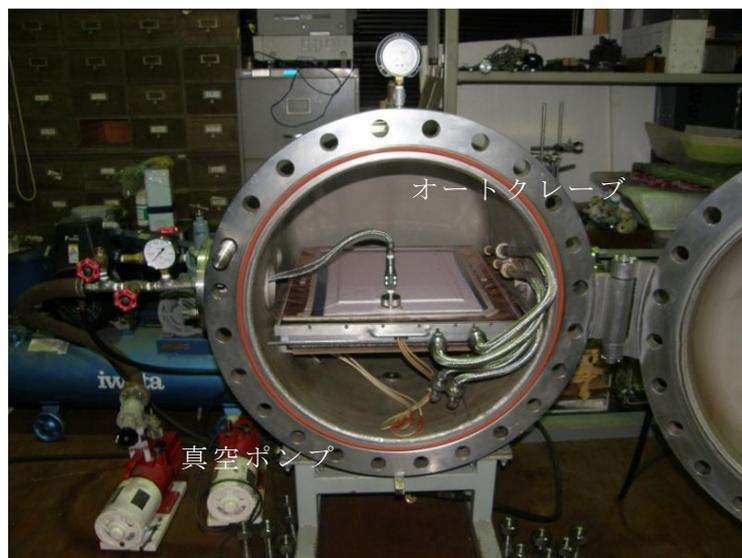
図 3.8 オートクレーブへの装着、真空引き
