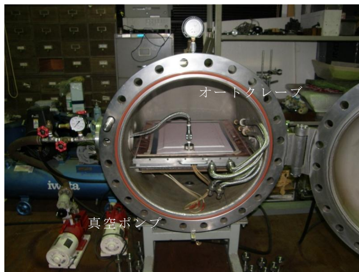
図 3.8 オートクレーブへの装着、真空引き
