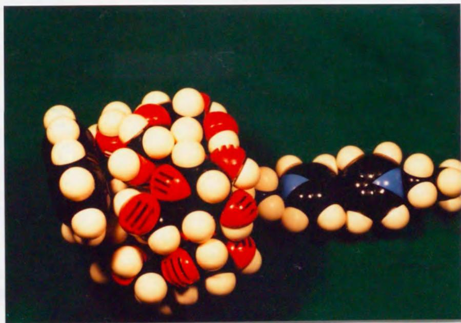
図 3 - 2 7  $C_2$  $C_{12}V$ - $\alpha$ -CD 錯体の推定構造とその CPK モデル
