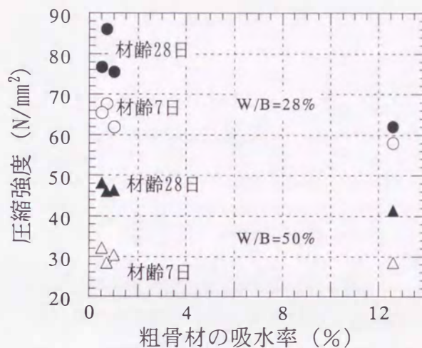
図-4.7 粗骨材の吸水率とコンクリートの圧縮強度
