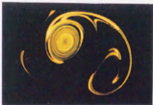
写真-5.9 渦輪の水表面への衝突による水表面の炭酸ガスの濃度境界層の取り込み過程の可視化
