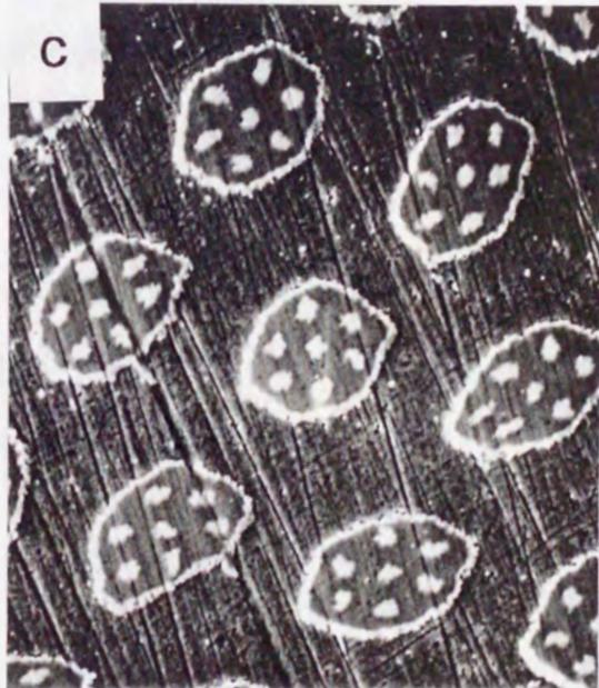
図2-21 SEMによる線材#2 (a)、#4 (b) 及び#5 (c) の最終線径10.2mm時のフィラメント形状および内部組織の観察結果。各線材ともピンングセンターであるNb形状の歪みが観察されているが、ピン間隔、及び配置はほぼ設計通り加工されている。
