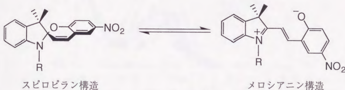
図3-10 スピロピラン系色素の可逆的な異性化反応
