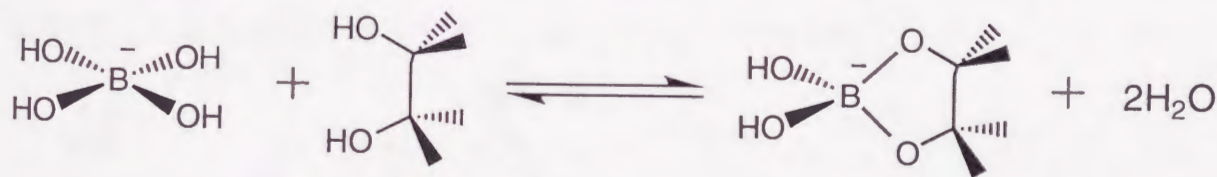
図2-5 ホウ酸とジオールとの反応
