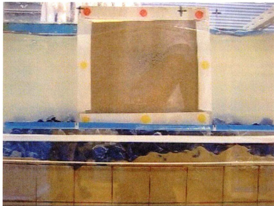
写真-1 実験後の防波堤模型の断面図
