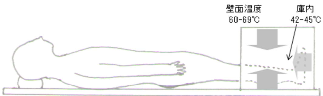
図4.2. フットサウナを仰臥位で使用した様子と出力50%時の壁面温度および庫内温度 ((株)フジカ提供資料の一部を改変)
