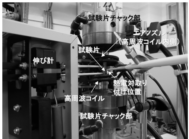
図3 熱疲労試験機。(a) 熱疲労試験片、(b) 熱疲労試験機の試験片周囲の拡大
