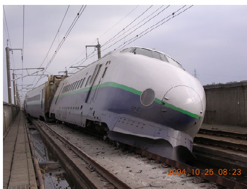
図 1-2 脱線した新幹線車両 (10 両目)
