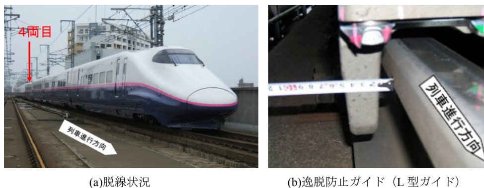
図 1-3 東北地方太平洋沖地震で脱線した新幹線車両 1-6)
