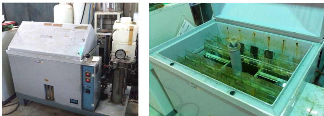
図 3-1 溶液噴霧試験機の外観
