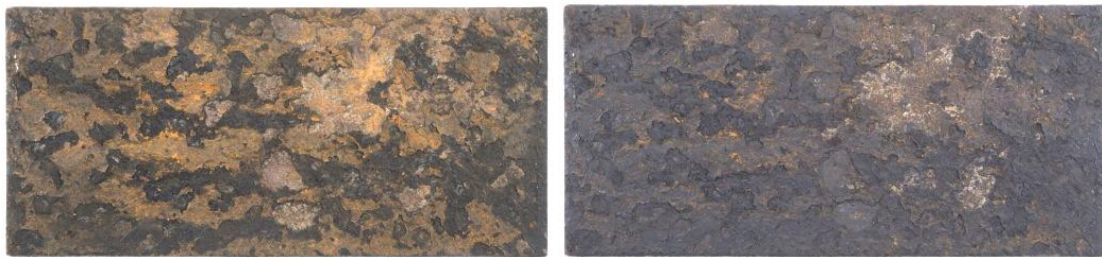
通电前の外観 (塩水噴霧 840 時間により作製した腐食鋼板) 通电後の外観
