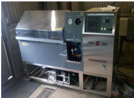
図 4-3 促進劣化試験に用いた試験機の外観
