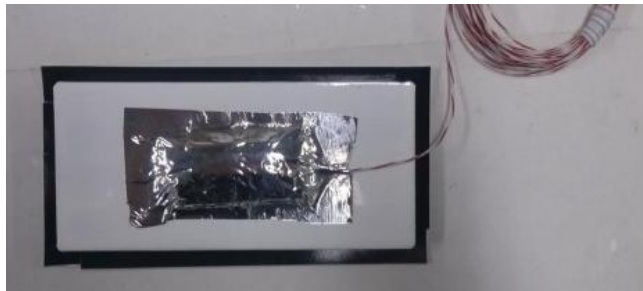
断熱材およびアルミテープでの被覆後
