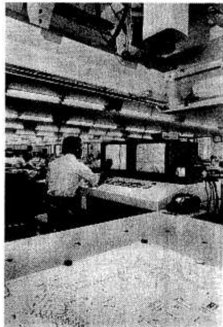
図面(手前)をテレビカメラ(上方)で写し、本社(東京)から工場(長崎)へ送る。画面を見ながら細部の修正や打ち合わせが瞬時にできる。—東京都港区の三菱重工で
