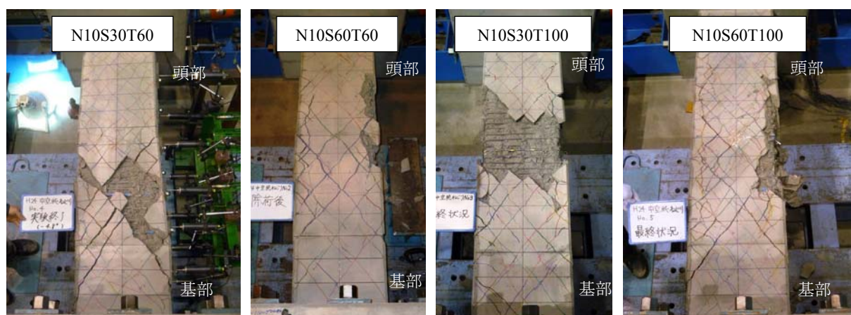
写真-2.3 実験供試体破壊状況の比較 (1室中空断面シリーズ)
