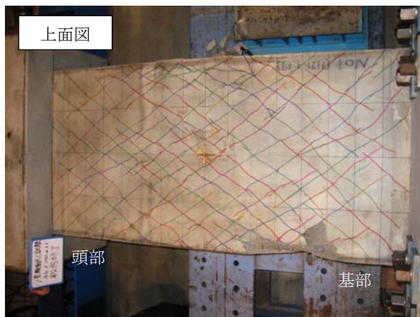
写真-2.4 実験供試体破壊状況 (3室中空断面シリーズ)
