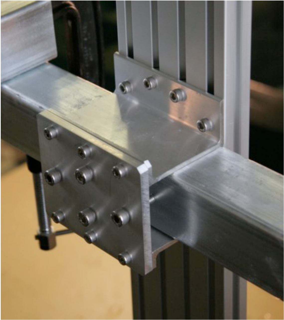
図9 アルミ構造材と鋼管バタの締付け金具
