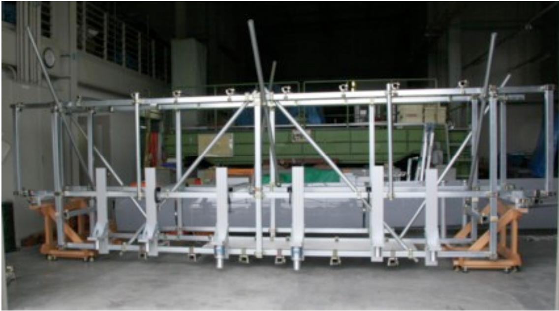
図 1 1 組立架台上の係留装置
