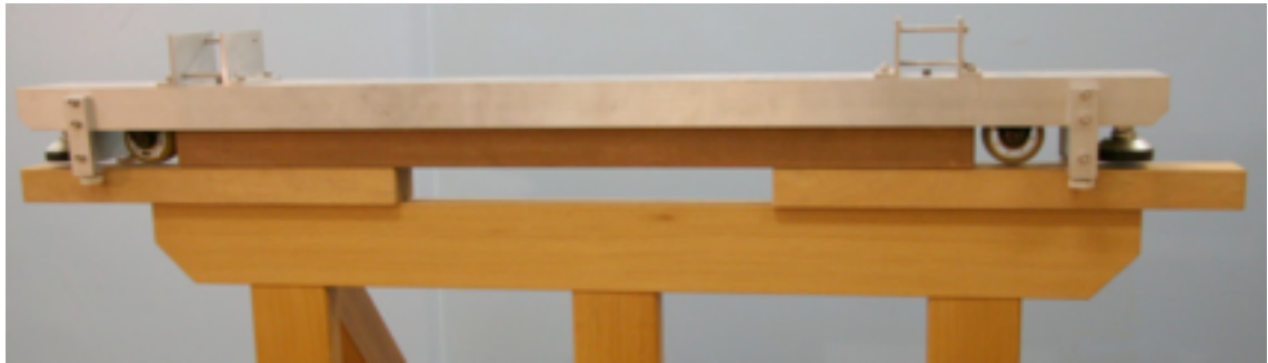
図3 移動台車の設置用枕木
