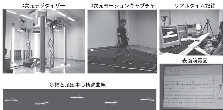
図5 デジタルバイシエント作成のための計測装置とその概要。3次元デジタイザーにより被検者の立体的形状をスキャンする。次にモーションキャプチャで歩行中の3次元の動きを捉え、それと同時に足圧計による足圧中心軌跡と歩幅、表面筋電図による大腿筋、下腿筋の筋放電パターンを計測し、歩行をデジタル化する。システム情報科学研究院・牧之内顕文教授（現 久留米工業大学）、芸術工学研究院・源田悦夫教授、デジタルメディスン・イニシアティブ・岡本剛准教授との共同研究
